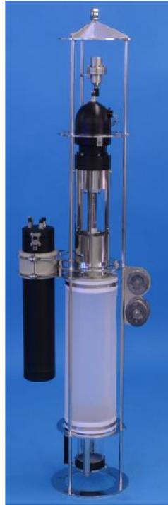
浮游生物泵可以通过一个抽水泵将海水中的物质（浮游生物、微塑料）抽滤到过滤网衣，样品最后被收集在网底管中，网筛与网底管的标配目径为  $60\ \mu\text{m}$ ，其他目径可以定制。
