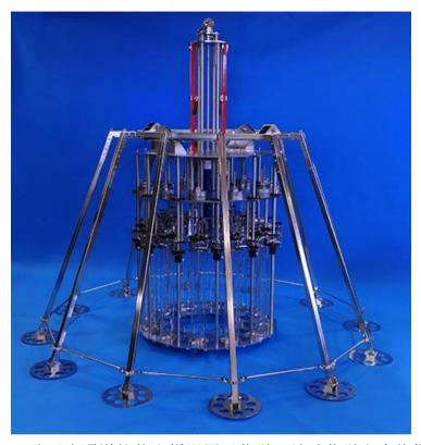
丹麦 KC-Denmark 公司多通道柱状取样器用于化学、地球化学和生物样品的应用。所取样品不会受到干扰,取样管可快速更换。
