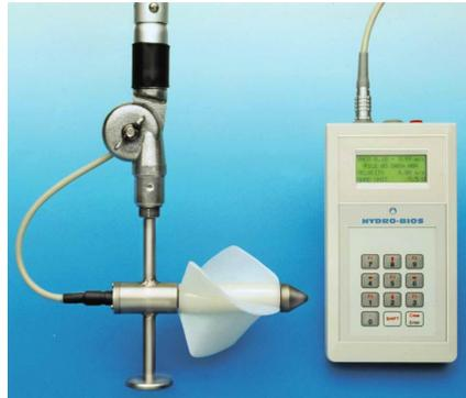
这台便携式点对点测量设备，它主要用来测量流动水的水流速度。杆持式测流计由伸缩杆下方的水流方向标和防水手持终端组成。测量头可以与伸缩杆成 90 度角。测量值可以在手持终端上显示和存储，存储的数据可以通过自带 Hydrolink 软件传输到 PC 上。测量数据文件在 PC 上以 ANSI 格式存储，因此很容易通过当今的文字处理软件分析表格软件和数据库软件进行估算和处理。
