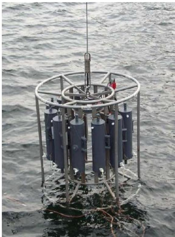
**MWS** 多通道水样采集器用于在水体中进行水样分层采集工作。它由一组坚固的、装有 12/24 个支架的不锈钢阵列组成，支架上可以安装容量为 1.7L 或 10L 的采样瓶，用来在一次操作中完成 12/24 个不同深度水样的采集工作。多通道水样采集器装有一个马达驱动的自动释放装置，上面集成一个压力传感器，传感器的测量范围可根据用户的工作要求进行选择。工作水深：3000 米，6000 米，11000 米。整套系统工作时电量消耗少，并且可以在温度为-40℃~+85℃的极端环境中正常工作。
