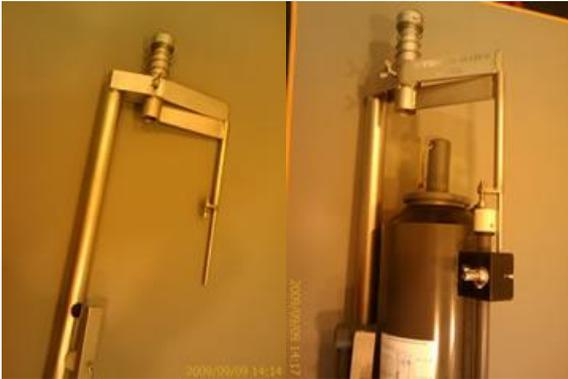
436 380 中间安装支架,适用于体积 1.0-2.5L 的塑料水样采集器
