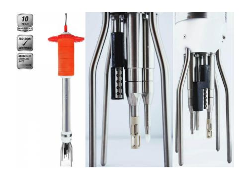
德国 Sea & Sun 公司的 MSS60 是一种用于测量微观尺度水体分层,以及小尺度湍流强度的多参数探头。它设计用于 500 m 内水深的近岸水域,河流和湖泊。MSS60 剖面仪可以在底部盖上安装多达 5 个不同的传感器(7 个不同的参数)。
