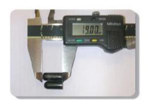
美国 Sonotronics 公司推出 PicoTag 系列发射器,它们是 Sonotronics 产品线中最小的声学发射器,水中重量从 0.6 克开始。这些微型发射器将使研究人员获得以前不可能获得的关于小型物种的有价值的信息。PicoTag 是标准的子弹状封装,如图所示。这种封装更常用于内部植入物或粘接发射器的情况下。可定制略微延长的封装,可包含用于外部安装的小钻孔。包装变化会导致重量和尺寸规格的变化。
