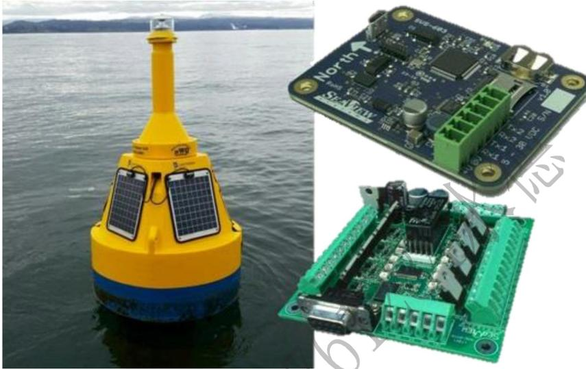
SVS-603 波浪高度传感器是一种基于 MEMS 的高精度传感器，可通过 RS-232 或日志向其车载数据记录器报告航向、波浪高度、波浪周期和波浪方向等数据。
